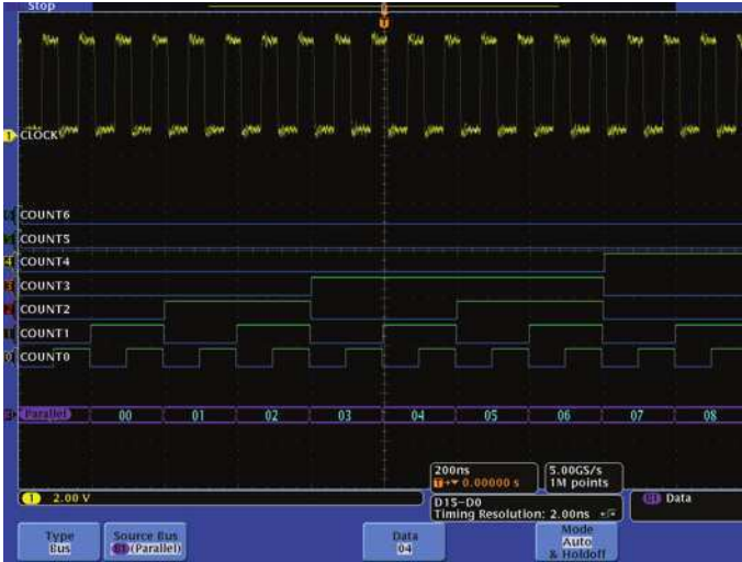
Şekil 56.Saatli veya saatsiz paralel veri yolu verilerini otomatik olarak tetikleyin, kodunu çözün ve arayın.
