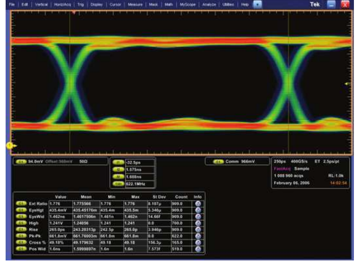
Şekil 7. 622 Mb/s seri veri göz modeli.
