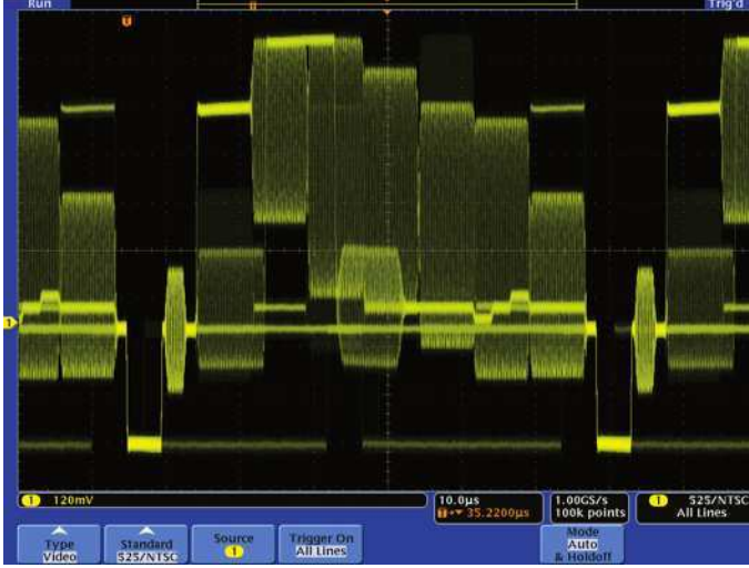
Şekil 6. NTSC kompozit video sinyali, karmaşık dalgaının bir örneğidir.
