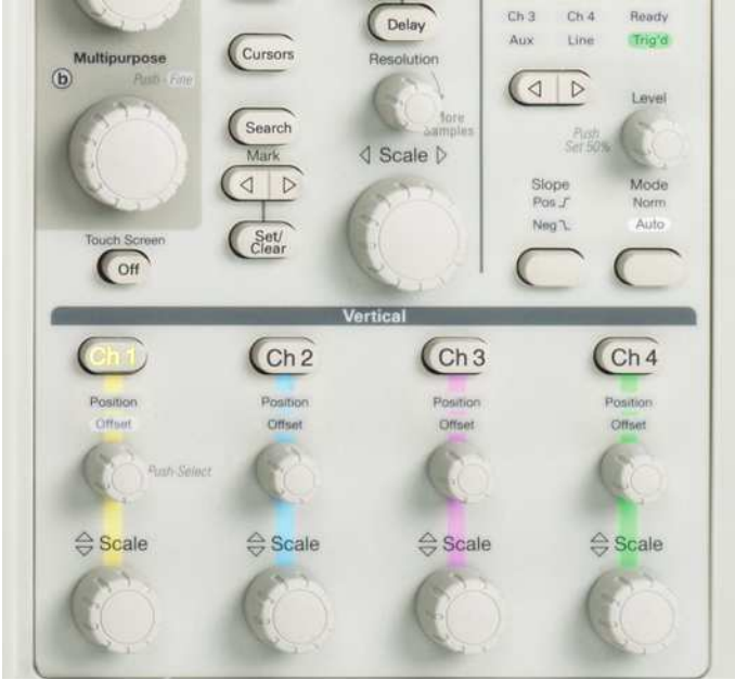
Şekil 60. Geleneksel, analog tarzda ki düğmeler konumu, ölçęi, yoğunluęu vb. tam olarak bekledięiniz gibi kontrol eder.
