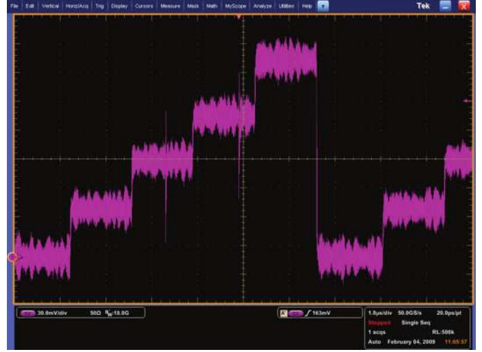
Şekil 24.Tepe tespit modu, osiloskobun son derece kısa geçici anormallikleri yakalamasını sağlar.
