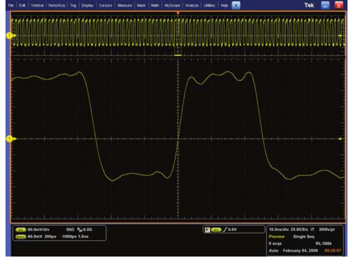
Şekil 50.DPO, çok daha yüksek dalga biçimi yakalama hızları ve üç boyutlu görüntü sunarak sinyal davranışına ilişkin üstün düzeyde bilgi sağlar; bu da onu geniş bir uygulama yelpazesi için en iyi genel amaçlı tasarım ve sorun giderme aracı haline getirir.
