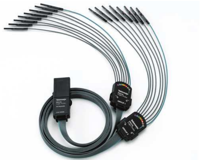
Şekil 43. Karışık sinyal osiloskopuna (MSO) yönelik mantık problemleri, cihazınıza dijital bağlantıyı kolaylaştırır.
