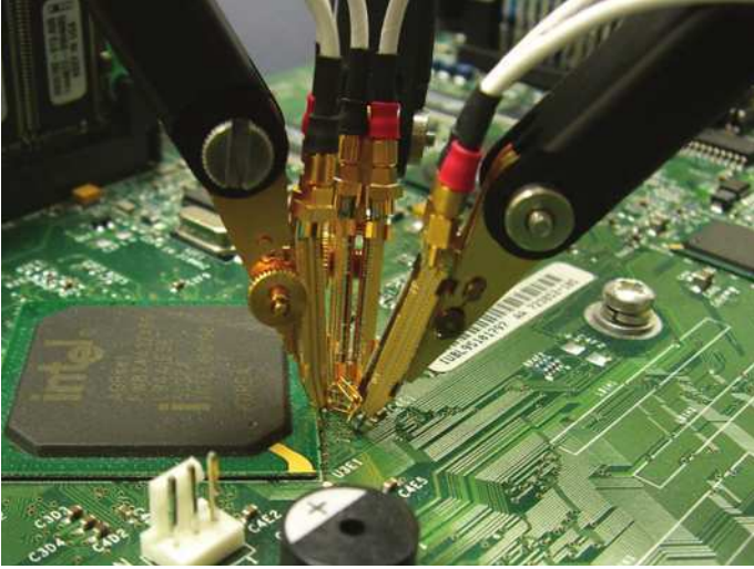
Şekil 41. Günümüzün bilgisayar veri yollarında ve veri iletim hatlarında bulunan hızlı saatleri ve kenarları ölçerken yüksek performanslı problar kritik öneme sahiptir.
