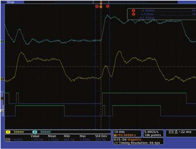
Şekil 52.MSO, zamanla ilişkili analog ve dijital sinyalleri görüntüleme ve analiz etme olanağı sağlayan 16 entegre dijital kanal sağlar. Yüksek hızlı zamanlama edinimi, aksaklıklar gibi dar kapsamlı olayları ortaya çıkarmak için daha fazla çözünürlük sağlar.
