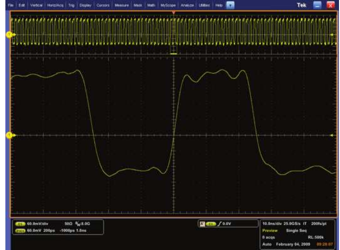
Şekil 46. Yüksek hızlı bir dijital sinyalin yükselme süresi karakterizasyonu.
