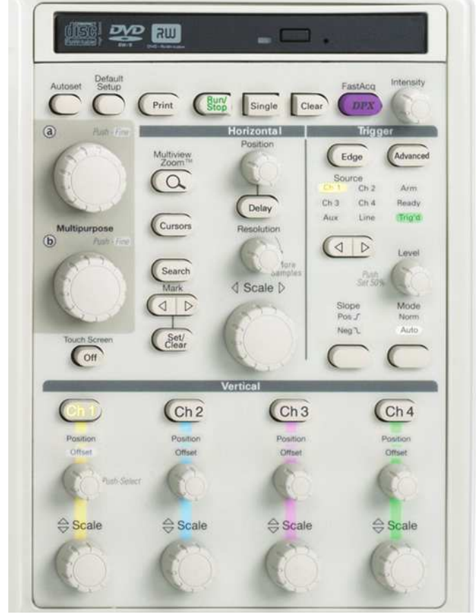
Şekil 20. Bir osiloskopun ön panel kontrol bölümü.
