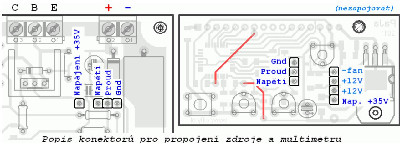
Gerilim ve akımı görüntülemek için, [elfly.pl](http://elfly.pl) web sitesinden bir multimetre bağlantısı kullandım , özellikle SMD ATmega8
