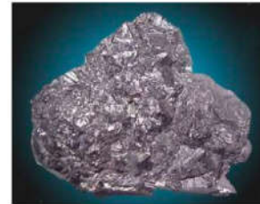
Kalkozin \rightarrow \text{Cu}_2\text{S} (% 79.9 Cu)
